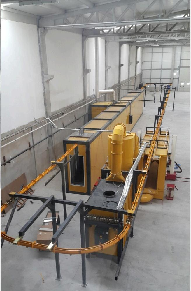
**У ПОВОРОТА ТИП ПЕЧИ ДЛЯ ОТВЕРЖДЕНИ / U TURN TYPE CURING OVENS**
